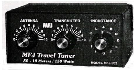
So kann der oben erwähnte Antennenkoppler typischerweise aussehen. Hier eine Version für die Bänder 80 – 10 m mit Ein- und Ausgangs-Drehko und schaltbarer Spule.
