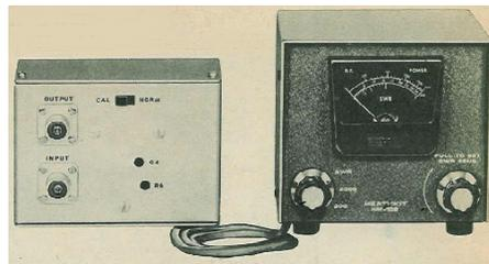
Ein SWR Meter mit einem Instrument und abgesetztem Sensorkopf. Der Nachteil der 1-Instrument Variante ist die Tatsache, dass zwischen Vor- und Rückwärtsleistung umgeschaltet werden muss. Dies macht Abstimmvorgänge etwas mühsam.
