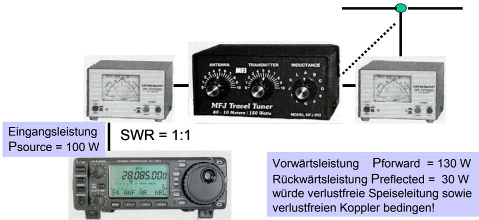
Es ist unter gewissen Betriebsbedingungen bei Vorhandensein von SWR sogar möglich das Phänomen zu beobachten, dass das SWR-Meter am Eingang des Antennenkopplers die echte Leistung des Transceivers anzeigt, während das SWR-Meter im Antennenkabel eine höhere Vorwärtsleistung anzeigt als den Wert der effektiven Eingangsleistung in den Antennenkoppler.
