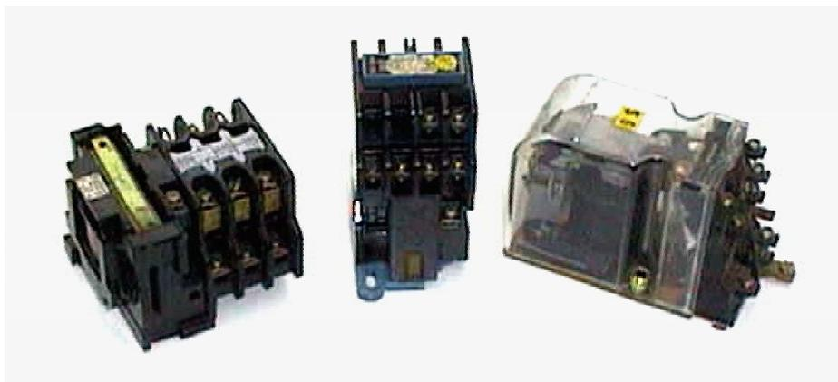
Den meisten Starkstromschützen ist gemeinsam, dass die Kontaktsätze gerade durchgehen. Dies ist eine gute Lösung zum verlustfreien Umschalten von Antennen. Starkstrom-
