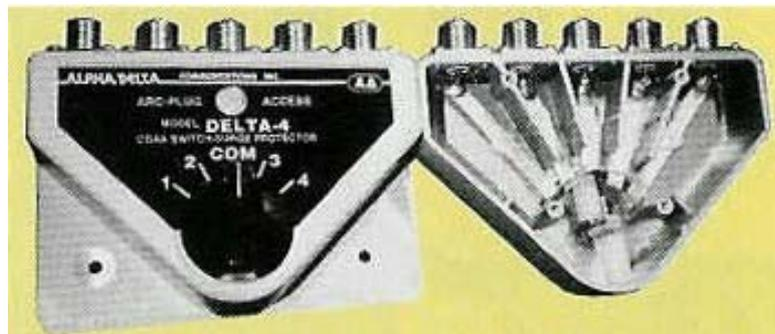
Das obige Bild zeigt einen typischen käuflichen Antennenumschalter für manuellen Betrieb. Dieser Umschalter ist zur Verwendung im Shack bestimmt. Bei guten Fabrikaten sind die jeweils nicht „aktiv“ geschalteten Antennen kurzgeschlossen und an Erde gelegt. Das Innenleben selbst ist keine Hexerei.
