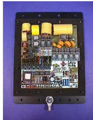
Es gibt zwar automatische Koppler die mit motorgetriebenen Drehkos arbeiten. Im allgemeinen sind jedoch bei automatischen Kopplern die Induktivitäten und Kapazitäten nach dem Binärprinzip in Festwerte aufgeteilt, die mittels Relais umgeschaltet werden. Eine Schaltung misst laufend das SWR und nimmt die Relaiseinstellungen vor. Gute automatische Antennenkoppler speichern für jede Frequenz den einmal gefundenen Abstimmwert.
