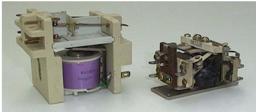
Bei beiden Relais gehen die Kontaktsätze gerade durch, dies sind beste Voraussetzungen zum Umschalten von Antennen.
