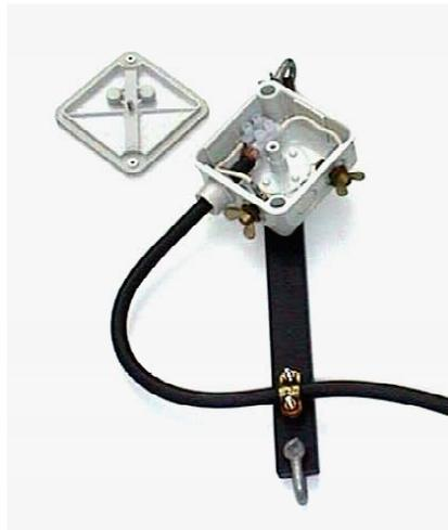
Dieses Anschlussstück stammt aus meinen eigenen Beständen. Es ist für den Anschluss eines vertikalen Dipols vorgesehen. Man nehme:
